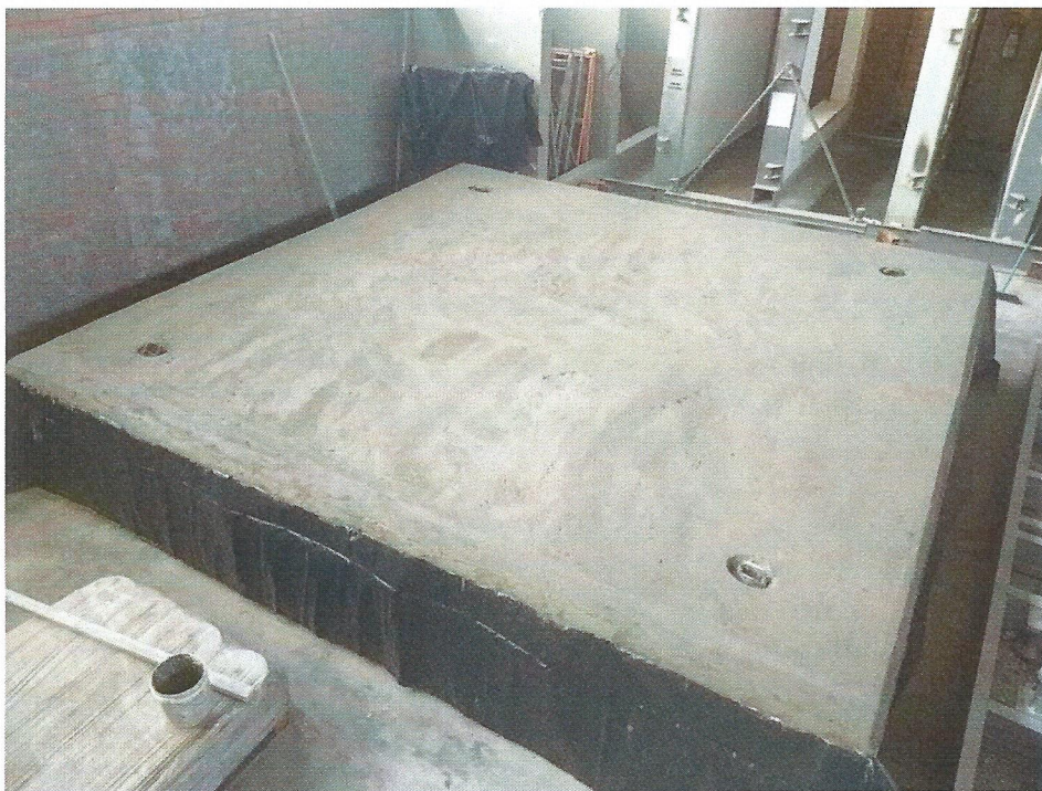
Figura – Amostra finalizada e em processo de estabilidade higroscópica
